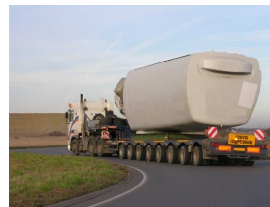
Transport de la nacelle
